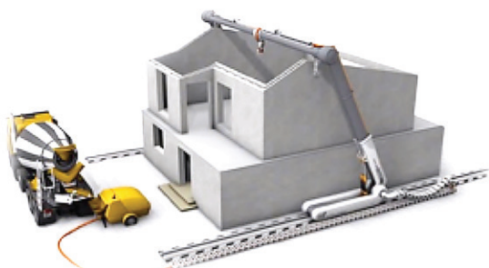
Η κατασκευή κτηρίων με τρισδιάστατη εκτύπωση από μπετόν και ανακυκλωμένα δομικά στοιχεία είναι ήδη πραγματικότητα
